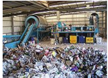
Maschinelle Trennung von Abfällen in einer Recyclinganlage
